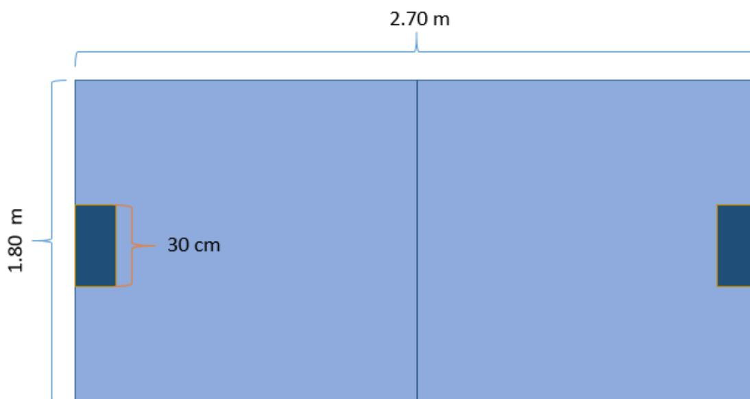
La pista contará con dos porterías con dimensiones de 30 cm de largo y 25 cm de alto, estas serán ubicadas en los bordes de la pista viendo hacia el centro de esta. Los robots deben contar con suficiente espacio para realizar las anotaciones. La pista contará con paredes de seguridad mayores a 15 cm.
